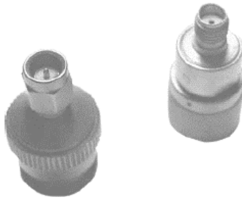
Obrázok 6-16. SMA: Sub-Miniature konektor, typ A.
